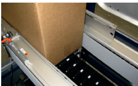
Boven: De doos wordt tijdens de verplaatsing gegrepen door de verend opgestelde band.
